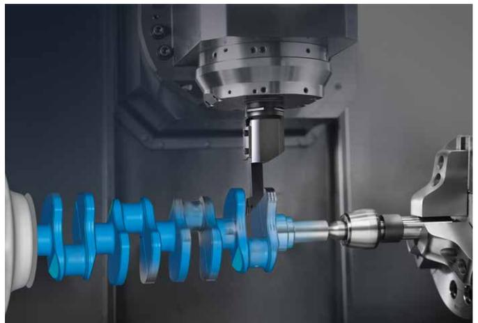
usinage spiral exigeant de multiples rotations de la tête et donc de retours arrière de celle-ci.
